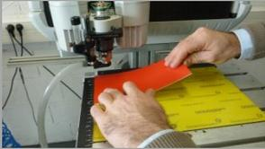
Placer et presser l'objet à graver sur le Gravogrip.
