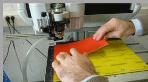
Placer et presser l'objet à graver sur le Gravogrip.
